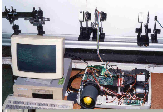
Figura 4: Montaje para la determinación de la torsión del eje director del televisor de cristal líquido
