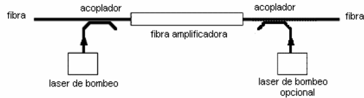
Fig. 2: Configuración básica de un amplificador EDFA (Erbium doped fiber amplifier)
